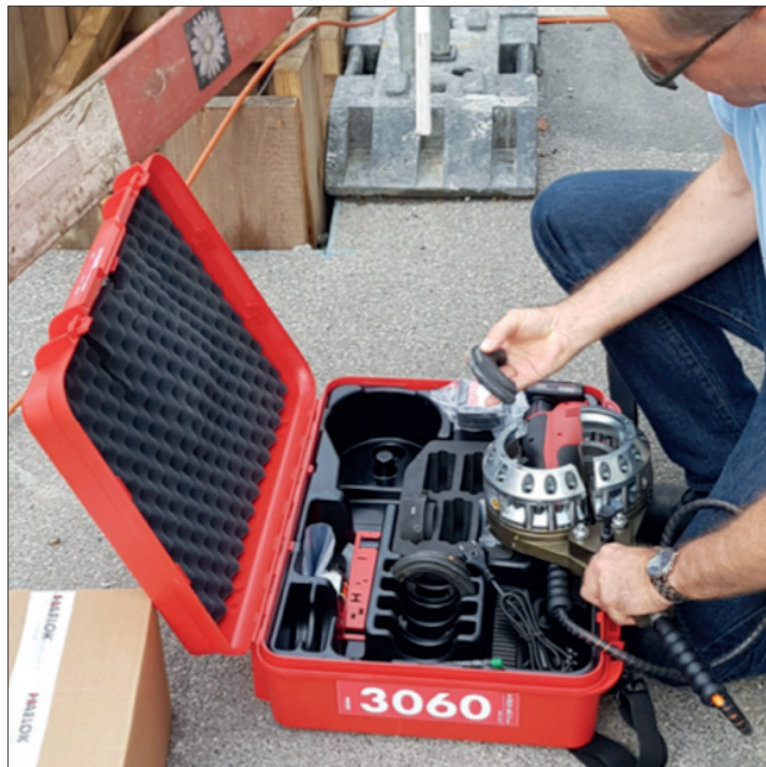
Bild 2. Mit dem Presswerkzeug wird jede Verpressung per Knopfdruck mit gleichbleibender Qualität realisiert
